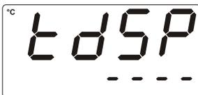
4- Cihazda Teknisyen şifresi varken , Teknisyen Şifresi Giriş Ekranında bu şifre girilmeden Set butonu ile ilgili Teknisyen menülerine girilmiş ise Cihaz , Teknisyenin parametrelerde değişiklik yapmasına izin vermez. Arttırma veya Eksiltme Butonuna basıldığında Alt Gösterge Ekranı yandaki gibi olur.
