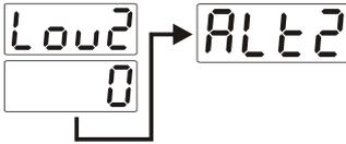
Alarm Çıkışı -2 için Alarm tipini belirler. Alarm Çıkışı-2'nin Lojik çıkış fonksiyonu alarm çıkışı olarak seçili ise bu parametre aktif olur.
