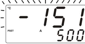
2- Üst ekran değerinin yanıp sönmesi : Analog Giriş'ten okunan değer ; kullanıcının belirlediği çalışma skalası minimum değerinden **LoL** küçük ise ekran değeri yanıp sönmeye başlar.
