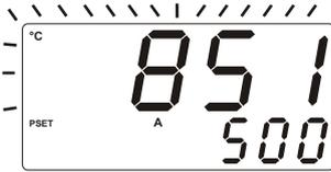
3- Üst ekran değerinin yanıp sönmesi : Analog Giriş'ten okunan değer ; kullanıcının belirlediği çalışma skalası maksimum değerinden **uPL** büyük ise ekran değeri yanıp sönmeye başlar.
