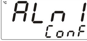
**6-** Teknisyen Menü seçenekleri içerisindeyken kullanıcı 120sn içerisinde herhangi bir işlem yapmazsa , Cihaz otomatik olarak ana çalışma ekranına döner.
