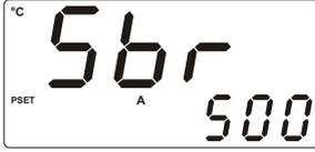
1- Analog girişlerdeki Sensör arızası. Sensör bağlantısı yanlış veya sensör bağlantısı yok.
