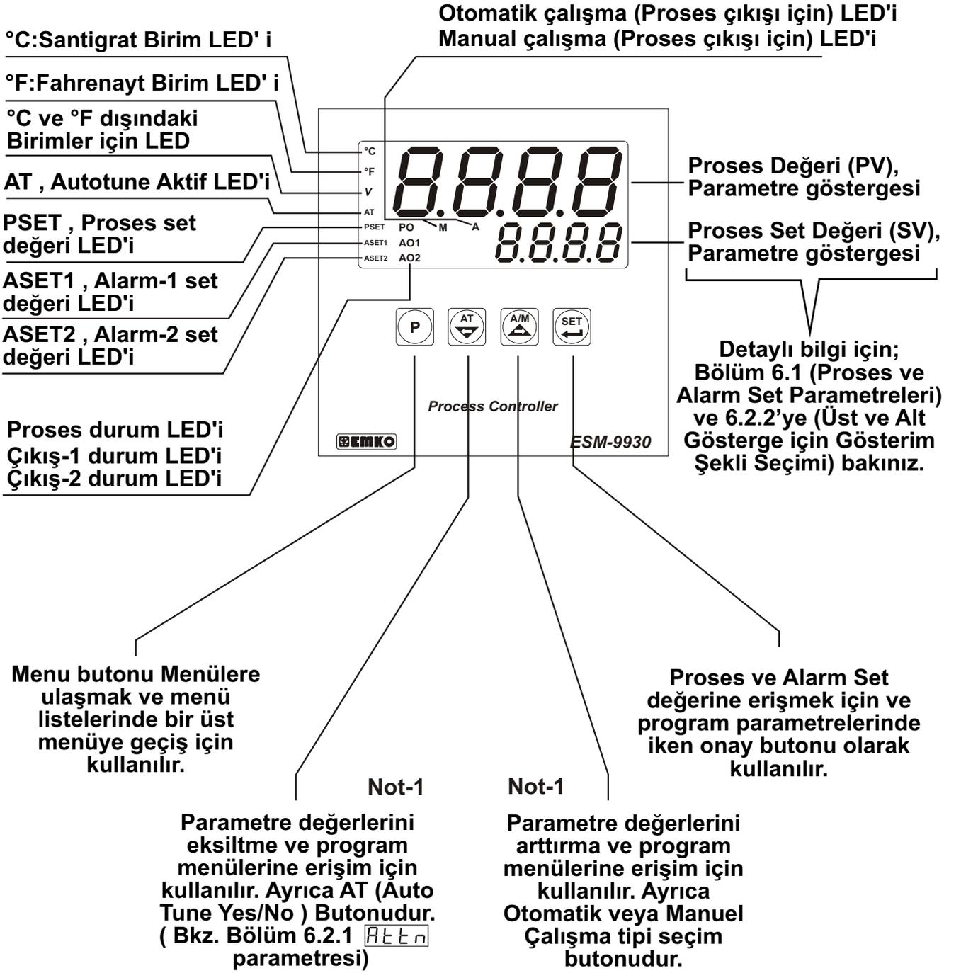
**Not-1: Parametrelerin içerisindeyken Arttırma veya Eksiltme butonlarına 5sn sürekli basıldığında Cihaz Arttırma veya Eksiltme işlemlerini 10'ar 10'ar , 10sn sürekli basıldığında ise 100'er 100'er yapar.**
