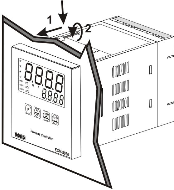
Cihaz panel montajına uygun olarak tasarlanmıştır.
