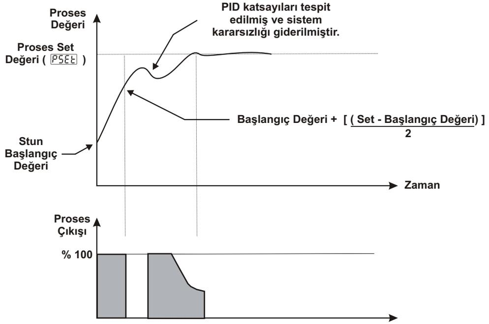
Soğutma fonksiyonun çalıştığı ve kontrol formu PID olarak seçilmiş sistemlerde ; Set değeri Proses değerinden küçük ise **Sıcaklık - [( Sıcaklık - Set ) / 2]** değerine kadar ;
