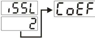
**CoEF** Voltaj /Akım girişi için çarpım katsayısıdır. Proses girişinden okunan Proses değeri bu parametredeki değer ile çarpılır.
