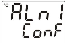
**6-** Teknisyen Menü seçenekleri içerisindeyken kullanıcı 120sn içerisinde herhangi bir işlem yapmazsa , Cihaz otomatik olarak ana çalışma ekranına döner.
