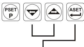
Proses Kontrol Tip seçimi *EnfS* = *onoff* olarak seçildiğinden ASET/Onay butonuna basıldığında , değişiklik kaydedilir ve K o n t r o l M e n ü s ü parametrelerinden çıkarılır.
