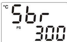
1- Analog girişlerdeki Sensör arızası. Sensör bağlantısı yanlış veya sensör bağlantısı yok.
