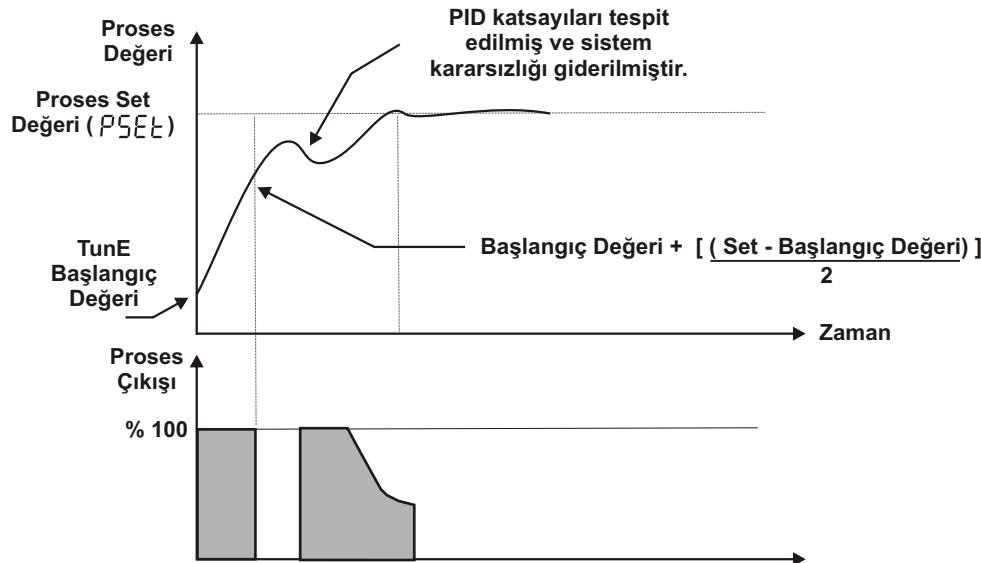
Soğutma fonksiyonun çalıştığı ve kontrol formu PID olarak seçilmiş sistemlerde ;
