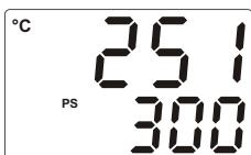
3- Analog girişten okunan değer Proses Set Üst Limit ( $P_{uPL}$ ) parametresindeki değerin üstüne çıktığında üst ekranındaki değer şekildeki gibi yanıp sönmeye başlar.
