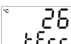
6- Programlama bölümü içerisindeyken Tune işlemini YES olarak seçtiğinizde Ana çalışma ekranında yandaki uyarı yazısı 10sn boyunca yanıp sönse Bölüm 7.1'de anlatılan Tune işlemi ile ilgili başlangıç şartları oluşmamış demektir.
