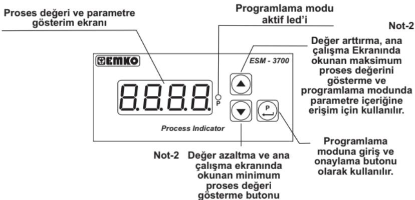
**Not-2:** Programlama modunda parametrelerin içerisindeki Arttırma veya Eksiltme butonlarına 5 sn sürekli basıldığında cihaz arttırmaya veya eksiltme işlemlerini 10'ar 10'ar, 10 sn sürekli basıldığında 100'er 100'er ve 15 sn sürekli basıldığında ise 1000'er 1000'er yapar.
