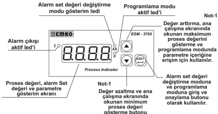
**Not-1:** Alarm set değeri değiştirme modunda veya Programlama modunda parametrelerin içerisindeki Arttırma veya Eksiltme butonlarına 5 sn sürekli basıldığında cihaz arttırmaya veya eksiltme işlemlerini 10'ar 10'ar, 10 sn sürekli basıldığında 100'er 100'er ve 15 sn sürekli basıldığında ise 1000'er 1000'er yapar.
