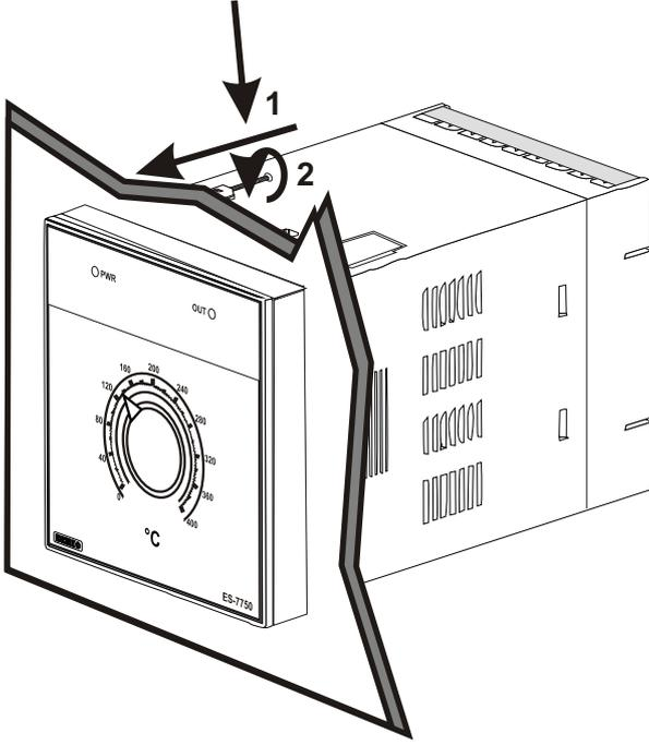
Cihaz panel montajına uygun olarak tasarlanmıştır.
